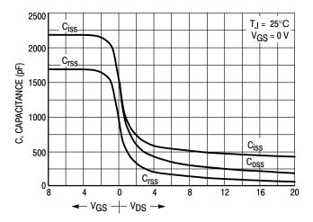
V<sub>DS</sub>, DRAIN-TO-SOURCE VOLTAGE (VOLTS)
